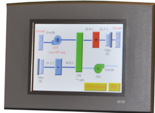
SPS C4 mit graphischem 5,7"-Touchdisplay. Fortschrittlichere SPS-Steuerung mit umfassenden Erweiterungsmöglichkeiten.
